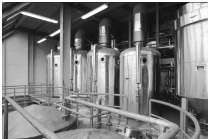
Odparka na zahušťování melasových výpalků denně produkuje 100t této suroviny
